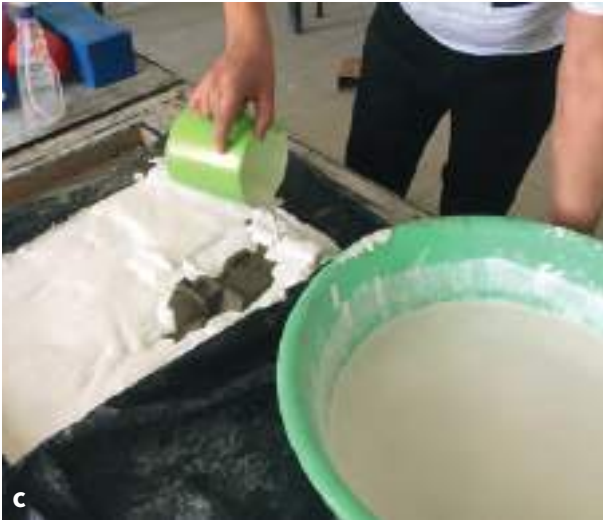
Görsel 3.100: Tek parça (yekpare) kalıp alma
