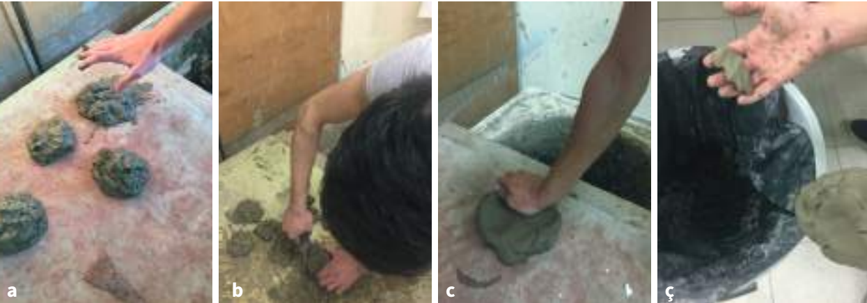
Görsel 3.24 : Kilin kullanıma hazır hâle getirilmesi
