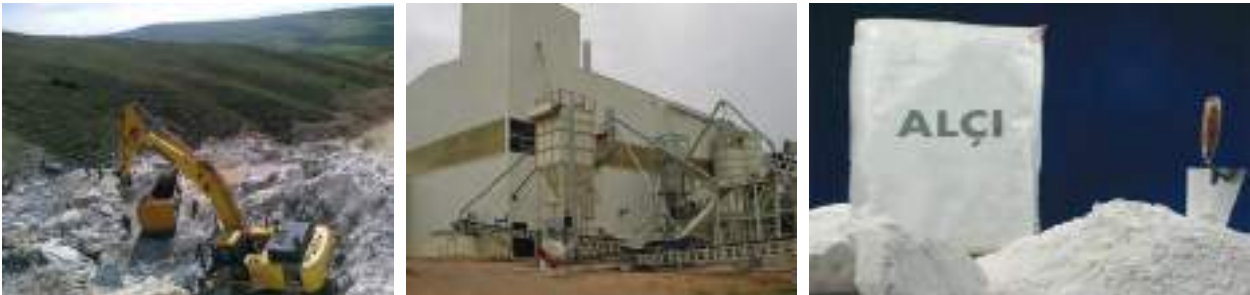
Görsel 3.97: Alçı doğada alçı taşı ocaklarından elde edilip işlenerek torbalanır.
