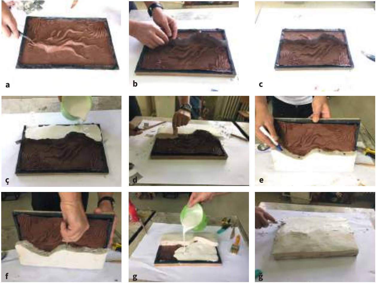
Görsel 3.101: Çok parçalı kalıp alma yöntemi
