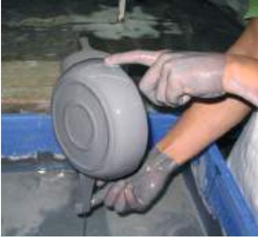
Görsel 4.61: Batırma yöntemi
