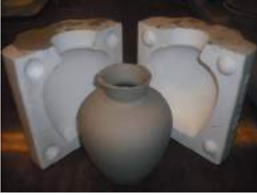
Görsel 4.14: Kalıp dökme tekniği
