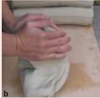
Görsel 4.46: Öküzbaşı tekniği ile kil yoğurma aşamaları
