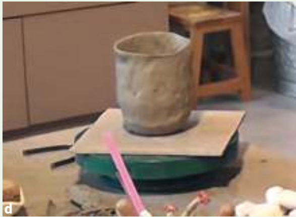
Görsel 4.16: Elle biçimlendirme (çimdikleme) yöntemi
