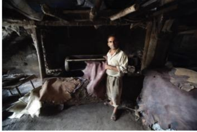
Resim 4.Palamut ve tetri şerbetinden çıkarılan deriler
