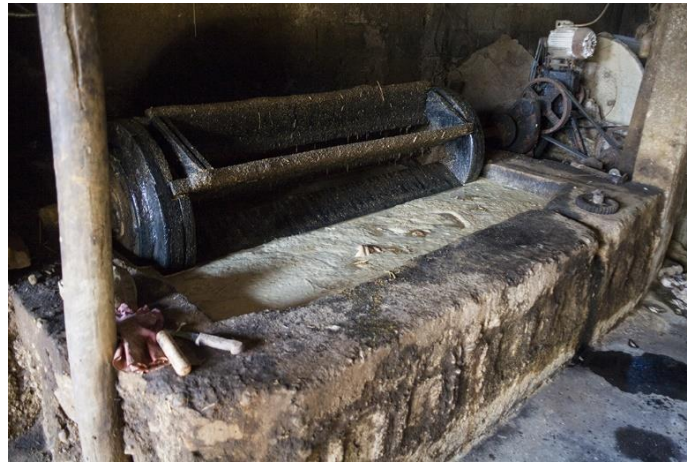
Resim 3. Palamut ve tetri şerbetine yatırılan deriler
