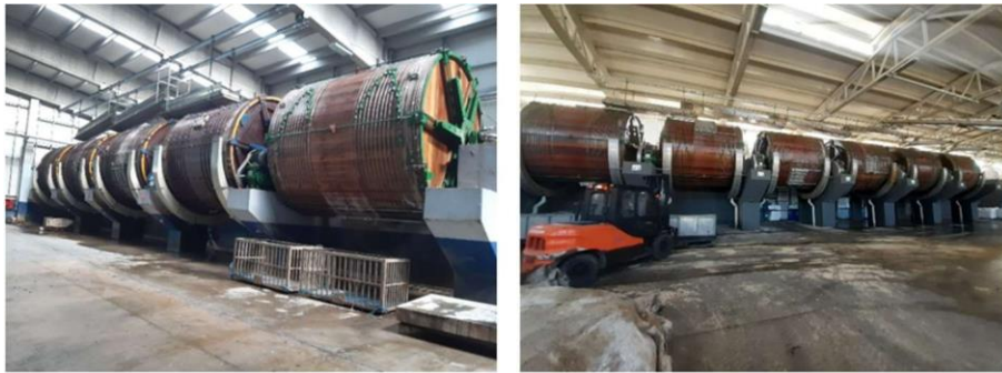
Görsel 3. İslatma ve Kireçlik işlemlerinin yapıldığı dolaplar
