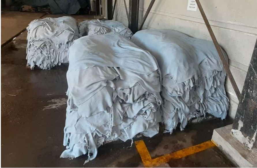
Görsel 6. Kromla tabaklanmış (Wet-Blue) derilerin istifte bekletilmesi
