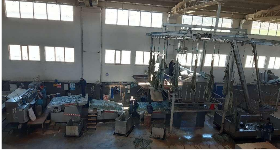
Görsel 4. Etleme (sağdaki) ve Yarma (soldaki) işlemleri
